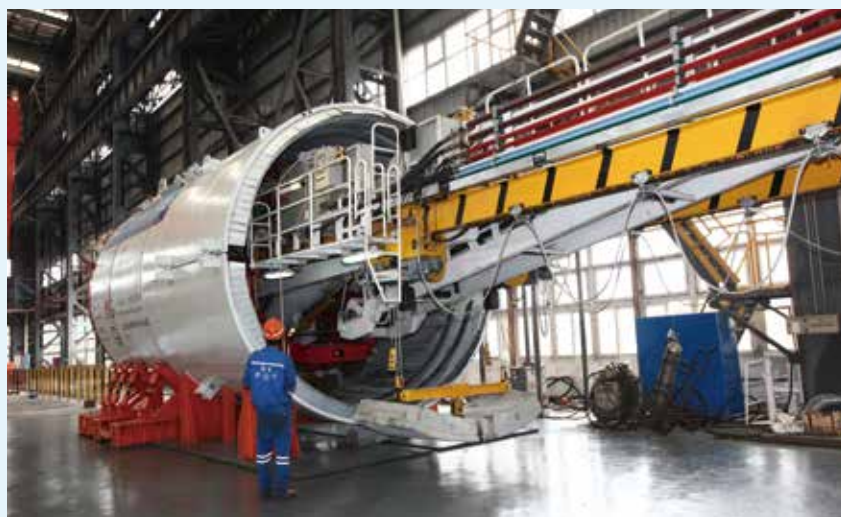
Tunnel boring machine fabrication in Shanghai 在上海裝嵌中的隧道鑽挖機
