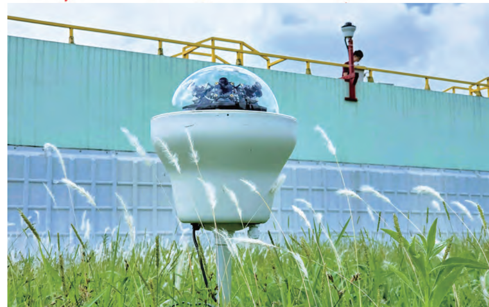
▲ 安裝於沙田污水處理廠的360度人工智能攝像機配備先進的「邊緣人工智能」技術，能追蹤及識別正在飛行的鳥類。透過監察鷺鳥種類、數量和習性，檢視並更好規劃「搬遷沙田污水處理廠往岩洞」工程的施工安排，藉以減低工程對環境的影響
