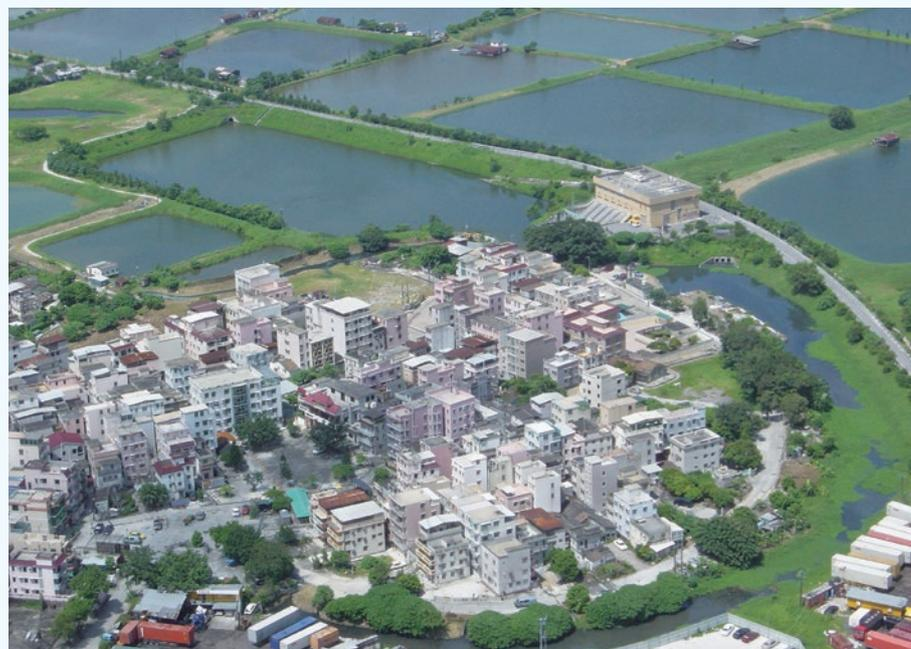
新田的鄉村防洪計劃包括建造雨水泵房和蓄洪池，並在鄉村外圍建造村路，令其成為環繞低窪村落堤堰的一部分。
