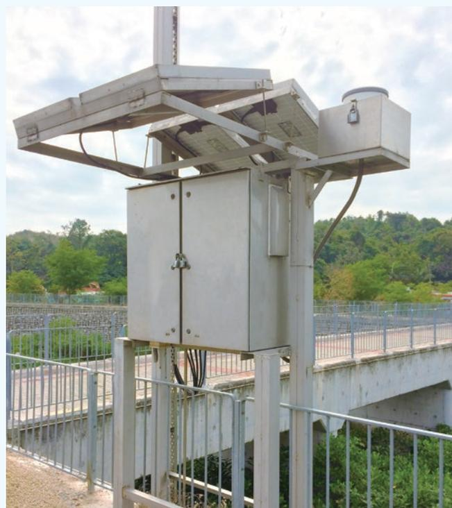
元朗馬田壘的遙控河道監察站，配以太陽能供電的網絡數碼相機作實時監察。
