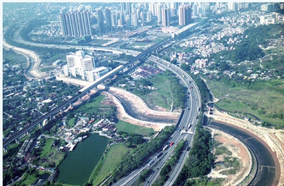
元朗排水繞道將部分流經元朗市中心的雨水疏導往元朗西面的錦田河，減低元朗市中心的水浸風險。
