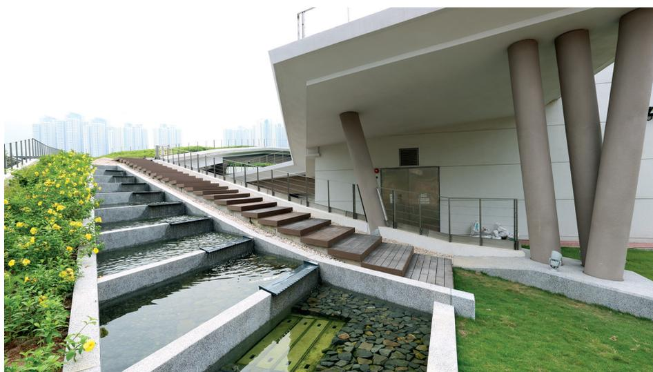
九龍城污水泵房設有雨水回用系統為水景設施提供水源
