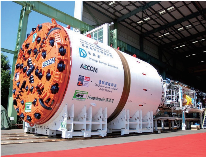
「混合盾構泥漿加壓式」隧道鑽挖機
