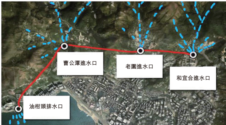
荃灣雨水排放隧道(紅線)收集雨水的途徑(藍線)
