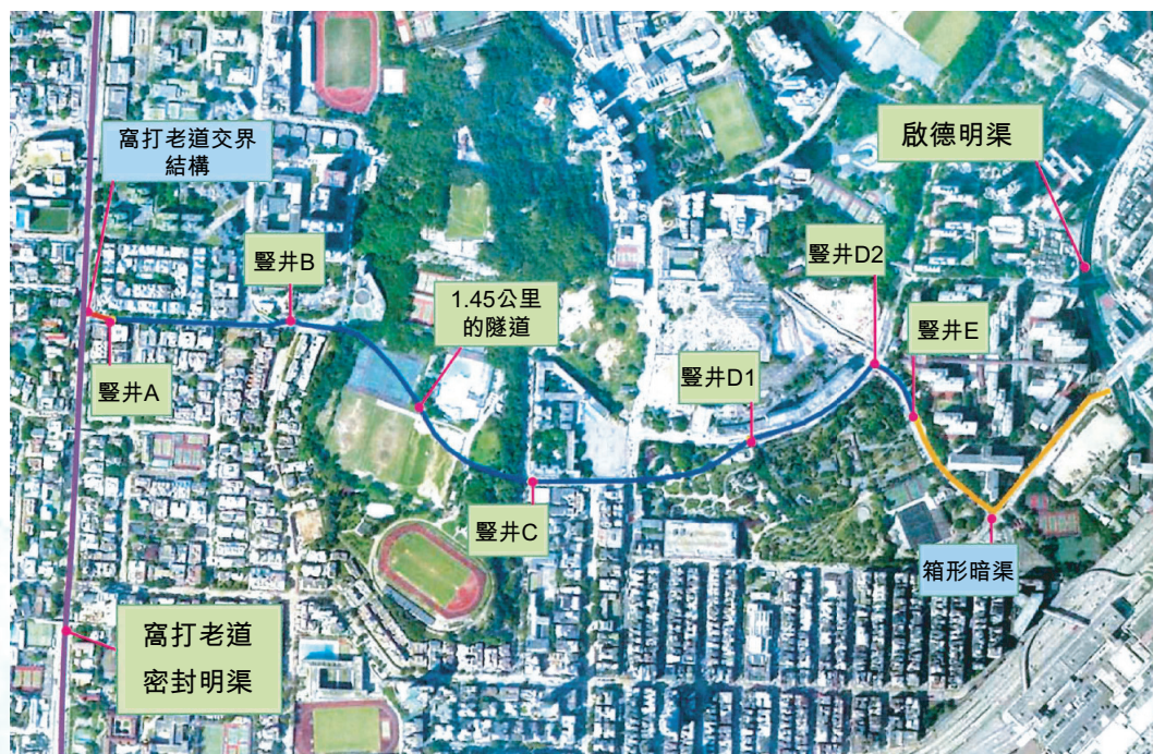
啟德雨水轉運隧道走線
