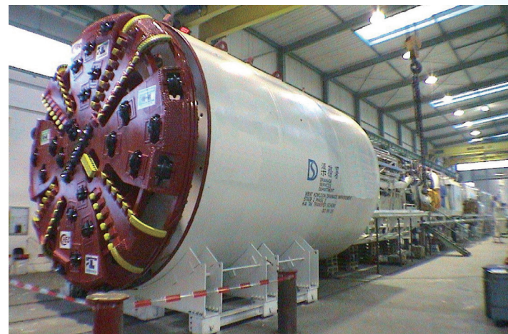
建造啟德雨水轉運隧道的隧道鑽挖機
