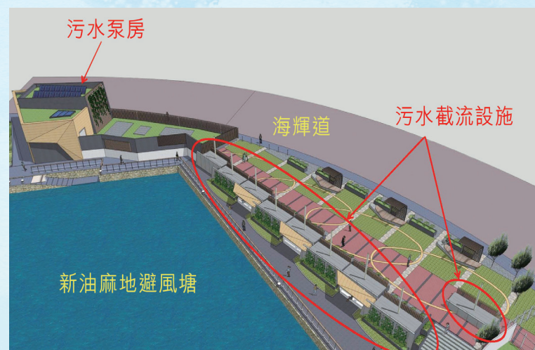
櫻桃街污水截流工程，有助堵截經雨水渠流入新油麻地避風塘的污水
