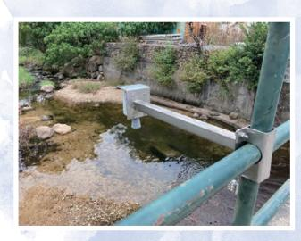
這系統全天候運作,在颱風季節發揮關鍵作用,持續追蹤河流、海岸和渠道的實時水位及流量變化,有助及早偵測水浸風險。這系統採用物聯網(IoT)感測器,在政府物聯通(GWIN)平台上運行,充分發揮長距離廣域網路(LoRaWAN)技術的優勢,包括廣泛覆蓋、低功耗、低成本、易於安裝和維修方便等特點。
