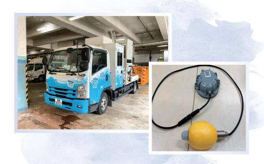
「智察得」先導計劃旨在減低污水從沙井 溢出的風險。我們在選定的污水沙井安 裝智能水位感測器,實時監察沙井內的 水位。當污水渠道被阻塞導致沙井水位 上升至警戒線時,感測器便會通過窄頻 物聯網傳輸技術即時發出警示,啟動三 合一清渠車處理及排查。它除了具備高 壓水流清理管道外,同時具備吸抽功能 清除管道內的淤塞物,內置於高壓噴嘴 的鏡頭能於洗渠的同時勘測渠內情況。
