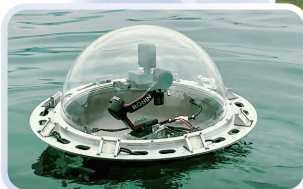
▼ 「不倒翁」球形地下管道檢測機械人 Tumbler Inspection Ball (TIB) Robot
