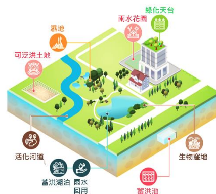
藍綠排水建設
