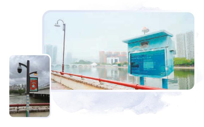
遠距離無線攝影機作防洪監察的智慧 渠務系統
