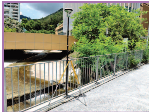
部門以全球導航衛星系統定位儀 (GNSS RTK) 實時測量傳感器的位置
