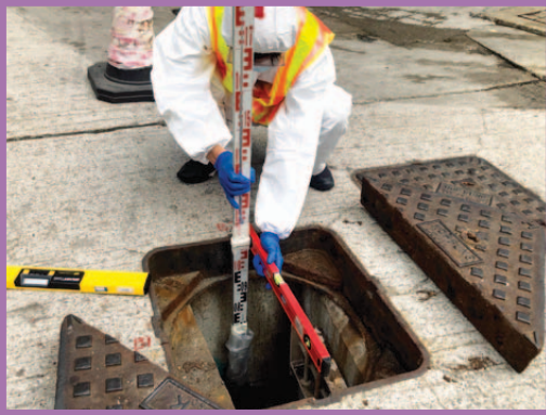
測量人員利用水準儀和望尺就地下管道的行水進行量度工作，並記錄相關測量數據
