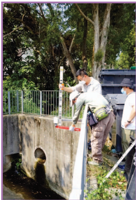
測量人員以高程測量方式量度傳感器的參考高度
