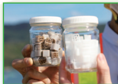
與 MBBR 技術有關的載體 [使用中（左）；全新（右）] 讓微生物依附生長，大大提升除污效能
