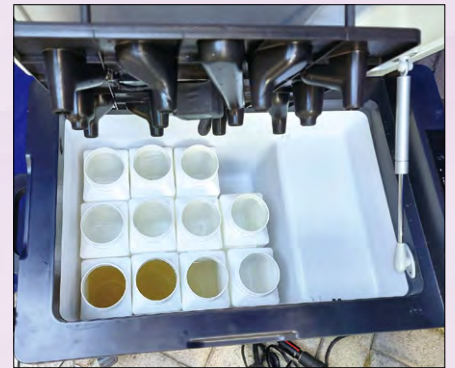
使用自動採樣機從污水井中抽取樣本，再把樣本瓶放入密封箱，然後運送到港大實驗室化驗
