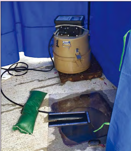
先以特製井蓋臨時蓋好擬採樣的污水井以防氣霧溢出，然後設置自動採樣機及其他採樣工具
