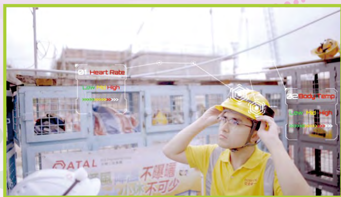
配合 BIM 系統使用的 IoT 智能安全帽有助於實時監察工作人員的身體狀況
