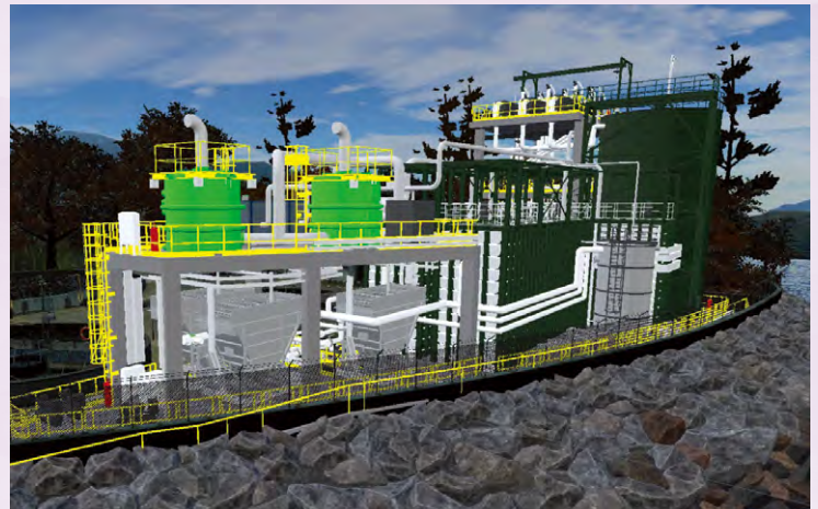
擬建臨時污水處理廠的 BIM 模型
