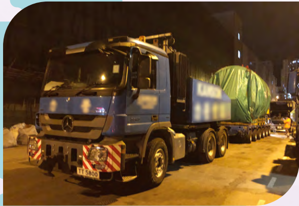
運輸車隊在狹窄多彎的路段運送隧道鑽挖機「小丸子」
