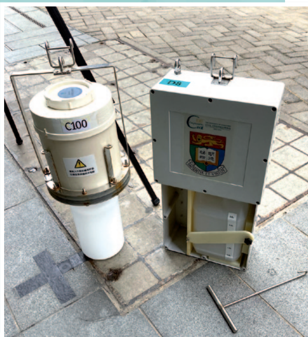
污水井內的自動採樣機 ( In-manhole auto-samplers )
