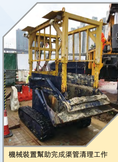
機械裝置可在箱形暗渠完全淹沒的情況下進行清理工作
