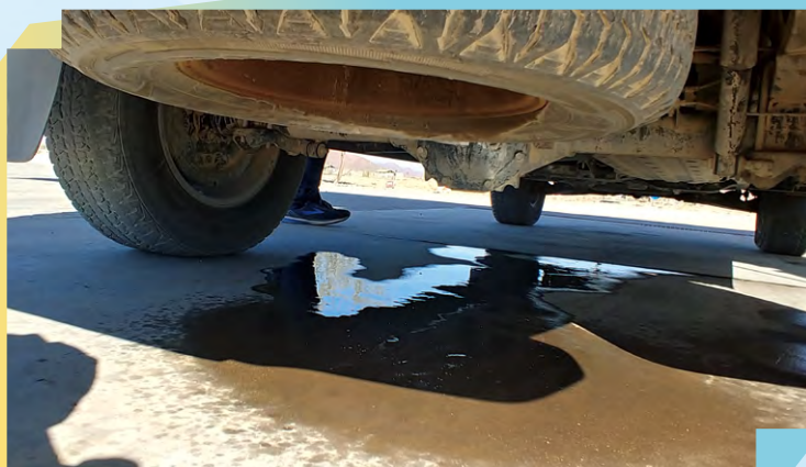
車底漏油情況
