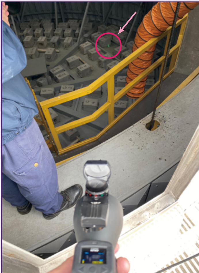
工作人員在生物氣儲存缸內測試激光甲烷遙測儀，將儀器的綠色光標（圖中以紅圈和箭咀標示者）對準目標位置
