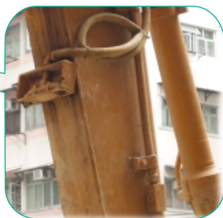
承建商合乎环保做法的好例子——在进行挖掘工程时，使用有洒水装置的挖土机以抑制尘土飞扬的情况
