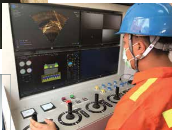
工作人員遙距操控清淤機械人 A worker remotely controls the desilting robot
