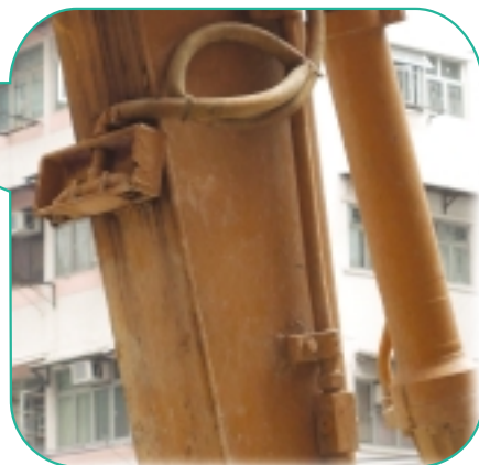
承建商合乎環保做法的好例子——在進行挖掘工程時，使用有灑水裝置的挖土機以抑制塵土飛揚的情況
