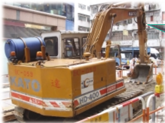
承建商合乎環保做法的好例子——在進行挖掘工程時，使用有灑水裝置的挖土機以抑制塵土飛揚的情況
